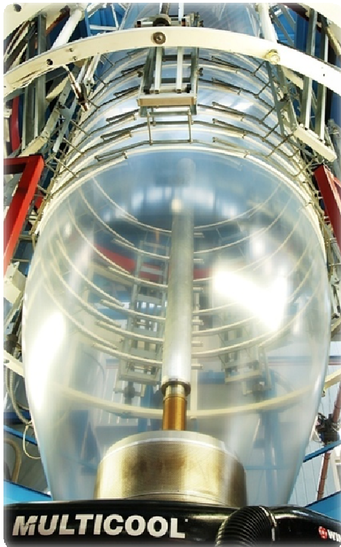
IMPIANTI BOLLA "BLOWN FILM EXTRUSION"
