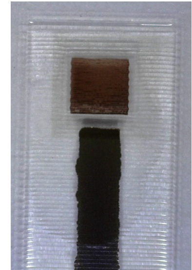
Elettrodo di nanotubi di carbonio (CNT) stampato a getto d'inchiostro, modificato con LDH
