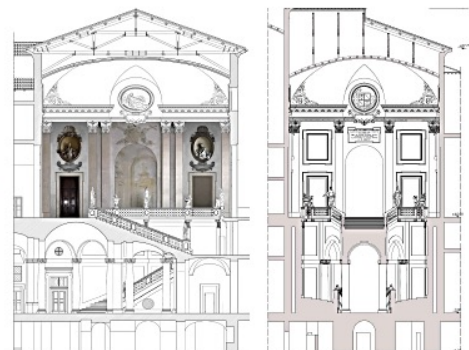
Sezione longitudinale e trasversale dello scalone di Palazzo Ranuzzi-Ruini poi Baciocchi.
