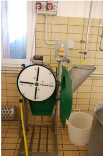
Il Tagliapasta ha al suo interno lame affilate per tritare la cagliata; l'attrezzatura è dotata di sistemi di sicurezza per cui le lame non si muovono se il coperchio non è chiuso; tuttavia durante lo smontaggio per la pulizia le lame rimangono scoperte; non toccare questa attrezzatura quando è aperta; **pericolo di tagli**
