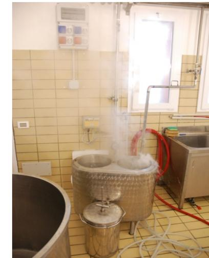
Il vapore utilizzato durante le lavorazioni può determinare scottature. È necessario durante la lavorazione fare **attenzione alle temperature pericolose**
